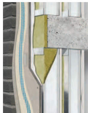
Kettős vázszerkezet impregnált gipszkarton köztes lemezzel
