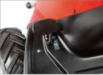
Differenciálzár, ami maximális tapadást biztosít bármilyen talaj és lejtés esetén.
