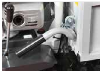
Kézi billentés automatikus reteszelőrendszerrel.
