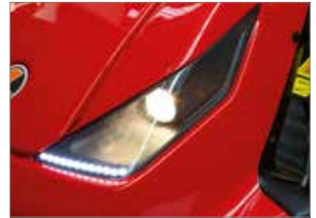
Halogén- és led lámpás első fényszórók, amelyek a nap kevésbé világos óráiban is jó látási körülményeket biztosítanak a vágás területén.
