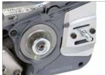
„OnBoard” tengelykapcsoló: gyorsan felszerelhető vágószerszám, tisztább tengelykapcsoló, az időtálló teljesítmény érdekében.
