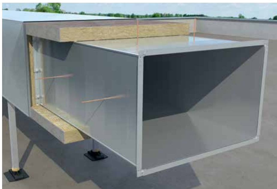
Kültérben vezetett légcsatornák szigetelését az időjárás hatásaitól védő burkolattal kell ellátni, pl. lemezburkolattal.
